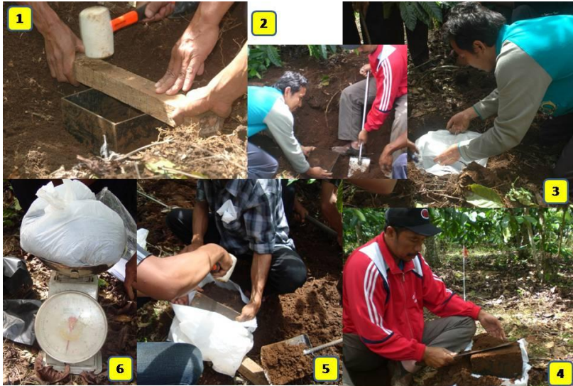
Gambar 5. Pengambilan contoh tanah utuh, (1) pembenaman ring besi ke dalam tanah, (2) pemotongan tanah di sekitar ring dan pengangkatan ke luar lubang, (3) Penutupan permukaan box besi tanah dengan menggunakan kantong plastik, (4) memotong kelebihan tanah pada ring hingga rata dengan permukaan ring, (5) memasukkan contoh tanah ke dalam kantong plastik dan pemberian label contoh tanah yang diambil, (6) Penimbangan berat basah tanah
