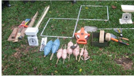
Gambar 5. Peralatan yang dibutuhkan untuk mengukur biomasa pohon
